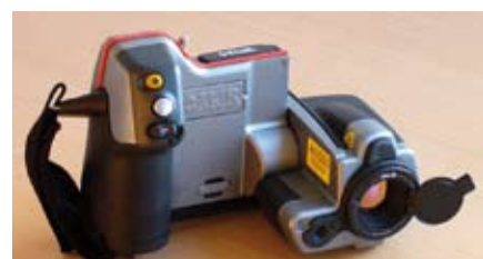
KAMERA: Det transportable kameraet har et touch-screen-display med penn for å kunne foreta markeringer direkte på stedet i det eksponerte bildet.
